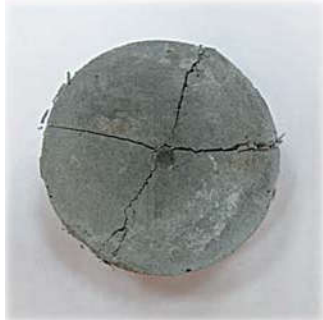
Рис. 4. Диск, армированный полипропиленовым волокном
