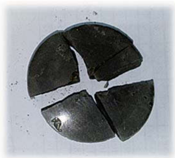
Рис. 3. Диск, армированный базальтовым волокном
